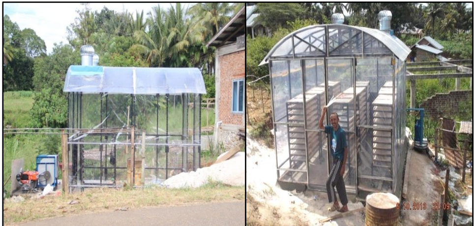
Gambar 11. Alat Pengering ERK hybrid LPG yang sudah dibangun
