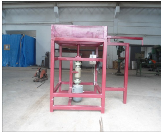
Gambar 18. Aparatus uji torsi pemotongan batang tebu
