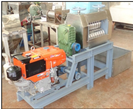
Gambar 5. Mesin Pemeras Nira Tebu
