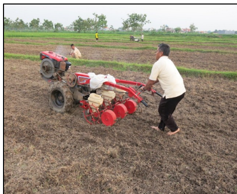
Gambar 23. Pelaksanaan pengoperasian alat Tanam Kedelai Secara Mekanis
