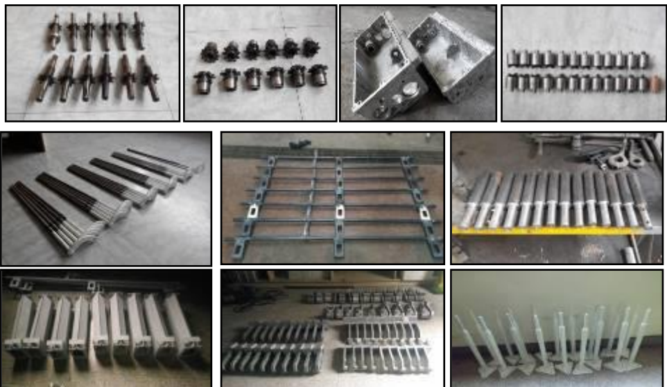
Gambar13. Komponen-komponen IJT (Poros Tansmisi Planting Arm, Casing Gearbox planting, Pen Screw , Poros Pengungkit Penurun Bibit, Unit Pemegang dan Penyetel Pelampung, Extension Shaft Roda, Neck Hub Connector, Casting Blok Transmisi Planting Arm , (Pemegang Pelampung Depan))
