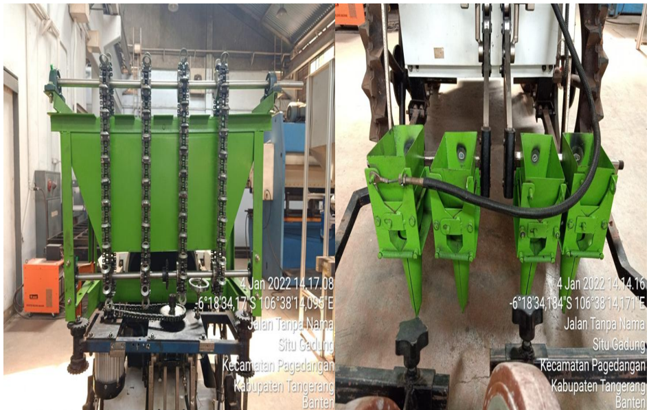
Gambar 15. Perakitan implement mesin tanam bawang putih
