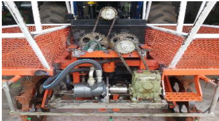
Gambar 4. Komponen pisau pemotong setelah modifikasi penggeraknya
