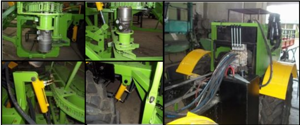
Gambar19. Posisi motor hidrolik, silinder hidrolik dan hand valve pada mesin panen tebu
