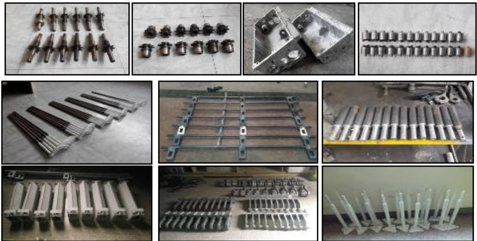
Gambar15. Komponen-komponen IJT ( Poros Tansmisi Planting Arm, Casing Gearbox planting, Pen Screw, Poros Pengungkit Penurun Bibit, Unit Pemegang dan Penyetel Pelampung, Extension Shaft Roda, Neck Hub Connector, Casting Blok Transmisi Planting Arm, (Pemegang Pelampung Depan) )
