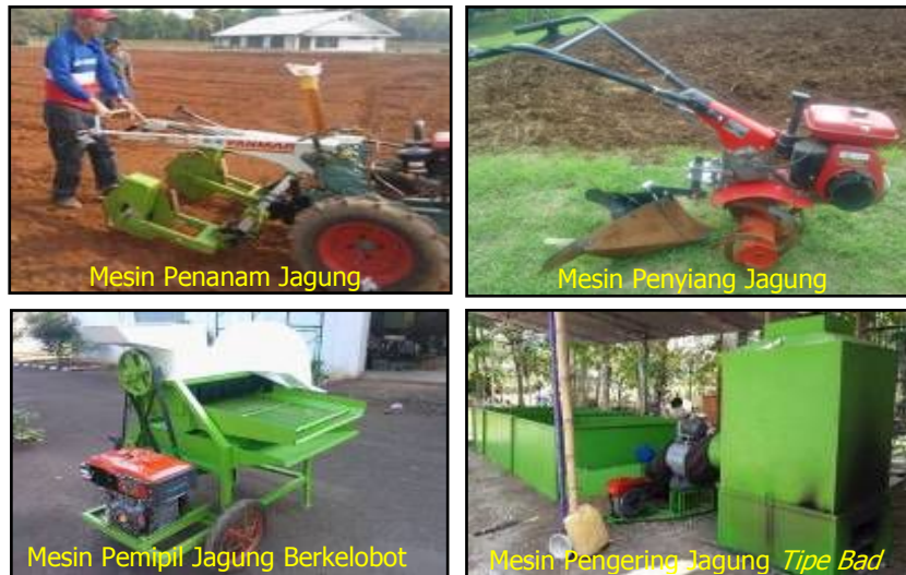
Gambar 7. Paket Mesin Budidaya dan Pascapanen Jagung (Mesin Penanam, Penyang, Pemipil dan Pengering Tipe Bad)
