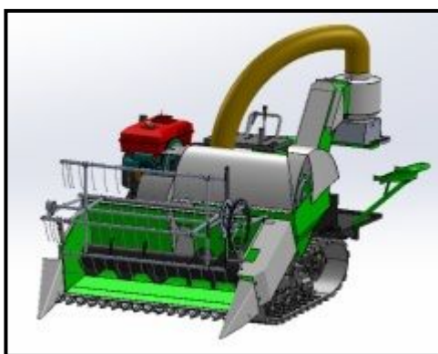
Gambar 2. Pendekatan desain awal mesin panen padi Tipe Mini Combine
