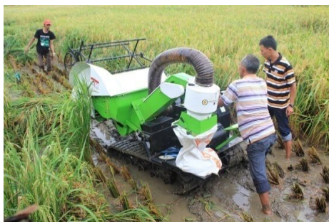
Gambar 3. Uji fungsi mesin panen padi Tipe Mini Combine
