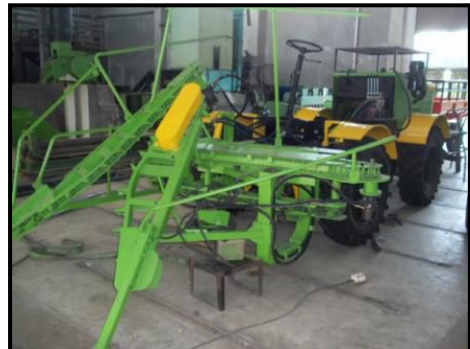
Gambar18. Proses perakitan prototipe Mesin Panen Tebu
