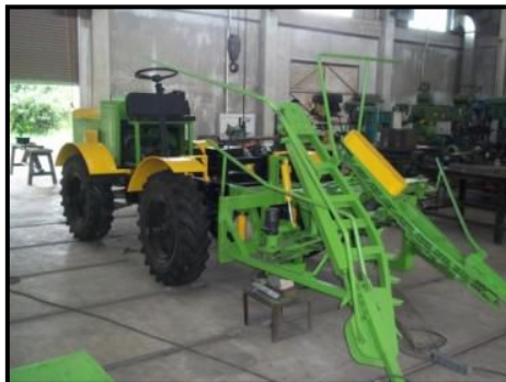
Gambar18. Proses perakitan prototipe Mesin Panen Tebu
