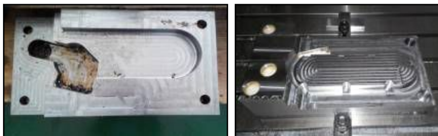
Gambar 12. Mold Prototipe Blok Transmisi Planting Arm IJT
